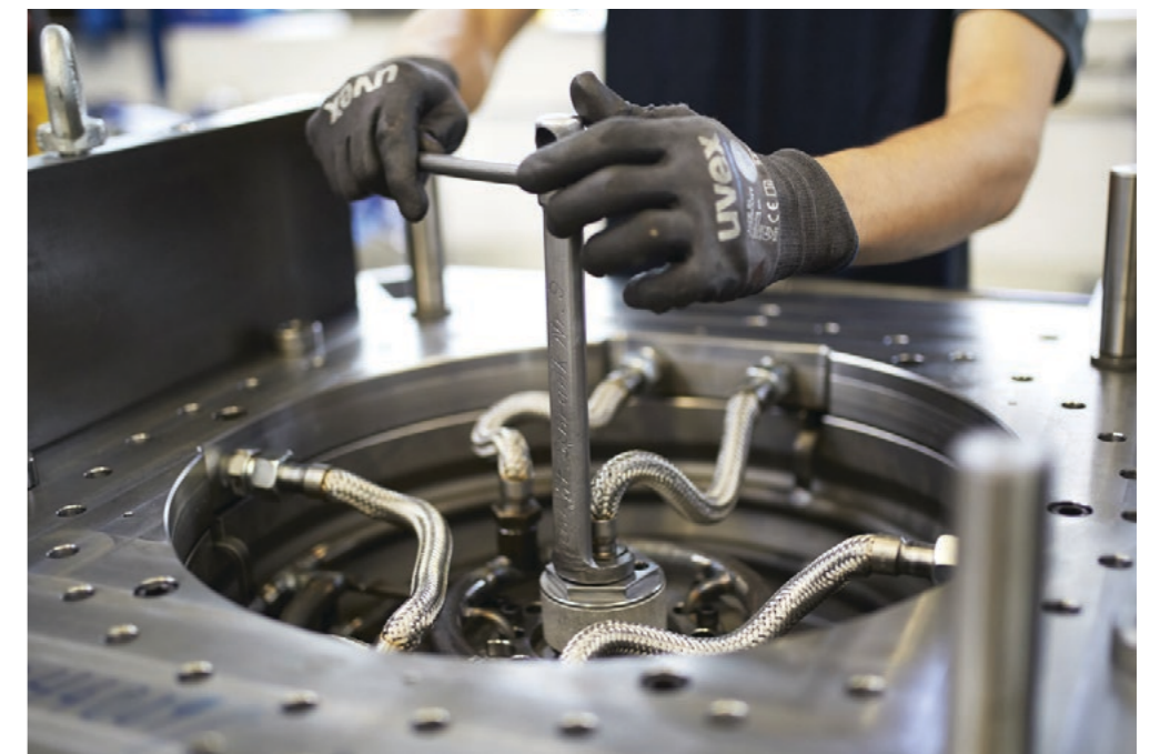
Bei Smart Casting werden Wasserkühlungen eingesetzt.
